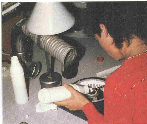
▲ Bild 10. Bei den Kalottenlautsprechern wird für jede Type spezifisch ein bestimmtes Coating aufgetragen. Dabei befindet sich das komplette Magnetsystem mit montierter Kalotte in einer Zentrifuge. Mit einem Pinsel werden die zu coatenden Stellen der Membrane eingestrichen, und die Menge der Coatingflüssigkeit durch eine wohl definierte Zentrifugengeschwindigkeit dosiert.
