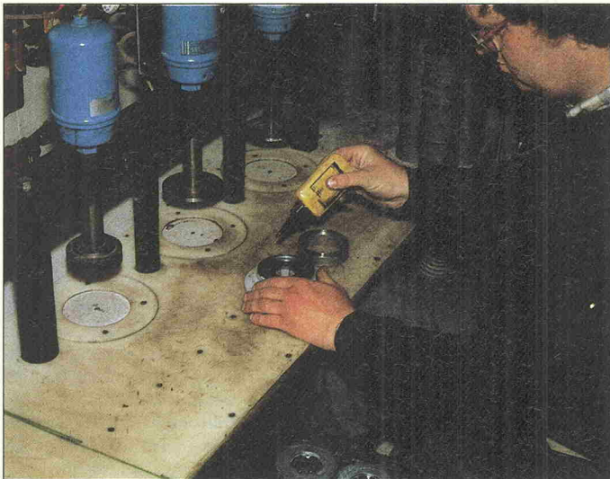
Bild 3. Die Magnetsysteme werden nach der Metallbearbeitung mit speziellen Paßwerkzeugen während des Verklebens ausgerichtet und dann mit Hilfe der blauen Stempel zusammengepreßt.
