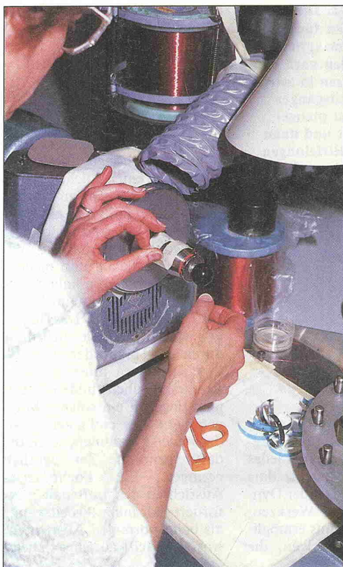
▲ Bild 4. Die Schwingspule, das Herz des Lautsprecherchassis, läßt sich bei kleinen normalen Systemen hervorragend auf Automaten wickeln. Die größeren Spezialschwingspulen erfordern allerdings einen besonderen Wickelaufwand. In diesem Fall werden sie komplett auf speziellen Halbautomaten gewickelt, damit bestimmte Wickelparameter genau eingehalten werden können.
