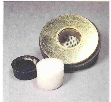
Die Mitteltonkalotte hat hinter der Membran ein bedämpftes und definiertes Luftvolumen. Hier ist der Plastikdeckel und die Schaumstoff-Dämpfung entfernt.
