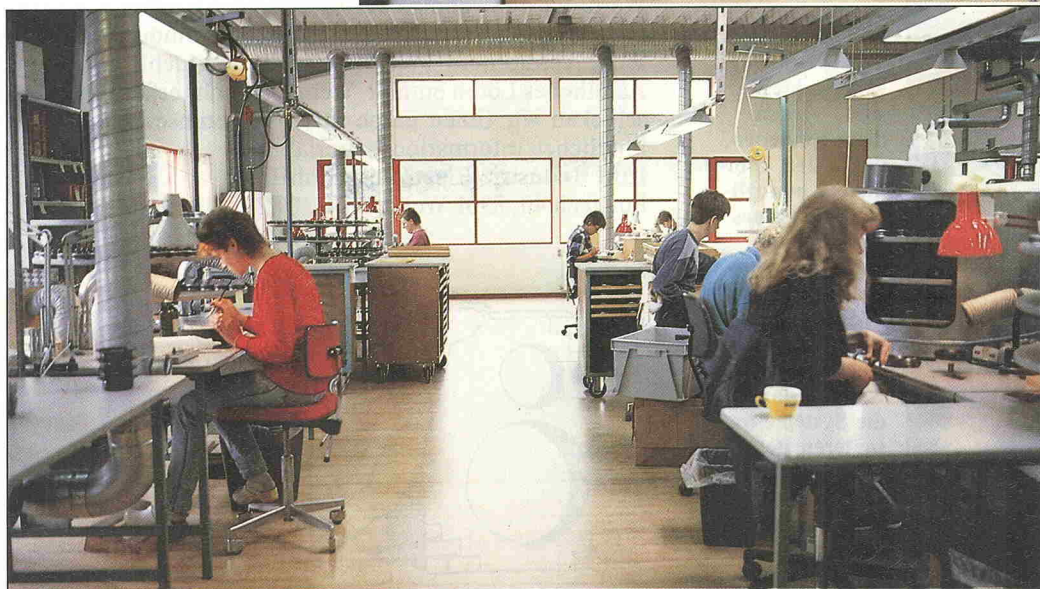
▲ Bild 11 und 12. In diesen Hallen werden die gezeigten Feinmontageschritte ausgeführt. Die Menge der notwendigen Arbeitsschritte ist recht beträchtlich. So wird zum Beispiel für die komplette Montage der Dynaudio D-28 AF eine Arbeitszeit von 28 Minuten kalkuliert.
