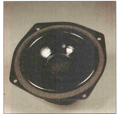
Die Membranbeschichtung des Baßchassis.
