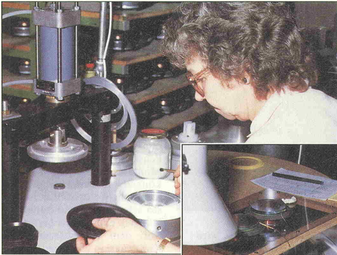
▲ Bild 7. Im nächsten Arbeitsgang muß die Schwingspule mit der Membrane verbunden werden. Dazu werden wieder spezielle Press- und Zentrierwerkzeuge benötigt, die das Verkleben der einzelnen Teile miteinander ermöglichen. Wichtig an diesem Arbeitsplatz ist — wie bei allen Stellen, an denen mit Klebstoffen hantiert wird — eine aufwendige Be- und Entlüftung der Arbeitszone, damit die Klebstoffe bei konstanten Temperaturen verarbeitet werden und die dabei entstehenden Dämpfe umweltfreundlich abgesogen werden können.
