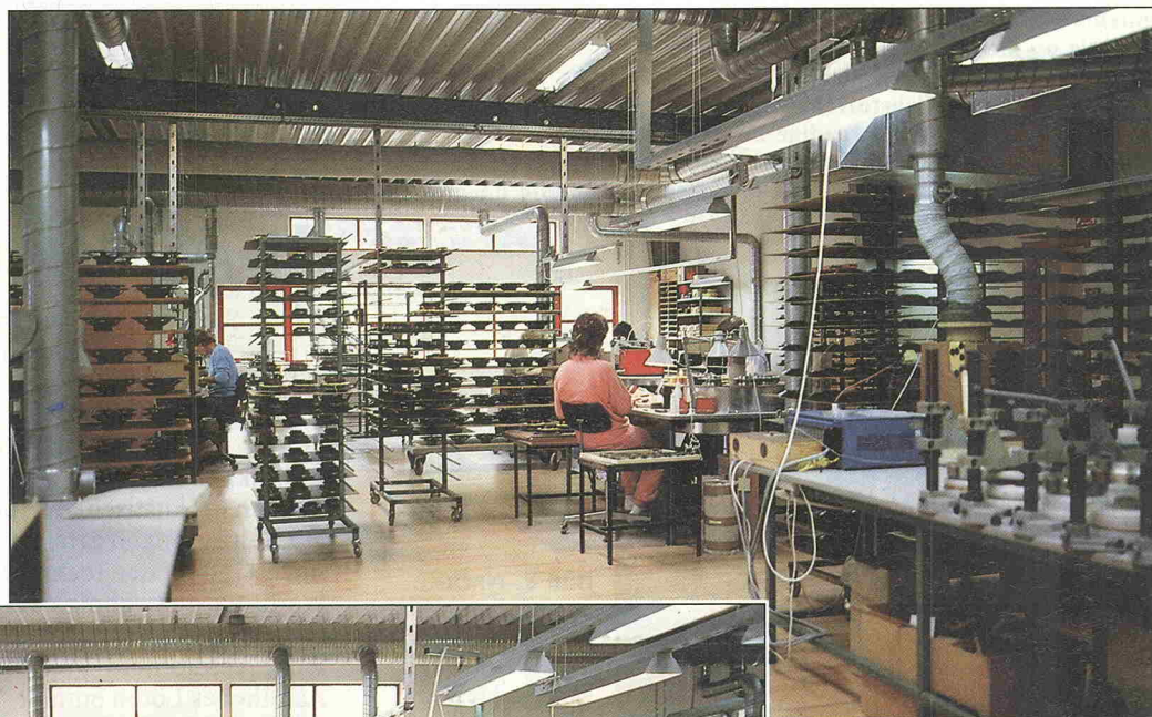
▲ Bild 11 und 12. In diesen Hallen werden die gezeigten Feinmontageschritte ausgeführt. Die Menge der notwendigen Arbeitsschritte ist recht beträchtlich. So wird zum Beispiel für die komplette Montage der Dynaudio D-28 AF eine Arbeitszeit von 28 Minuten kalkuliert.
